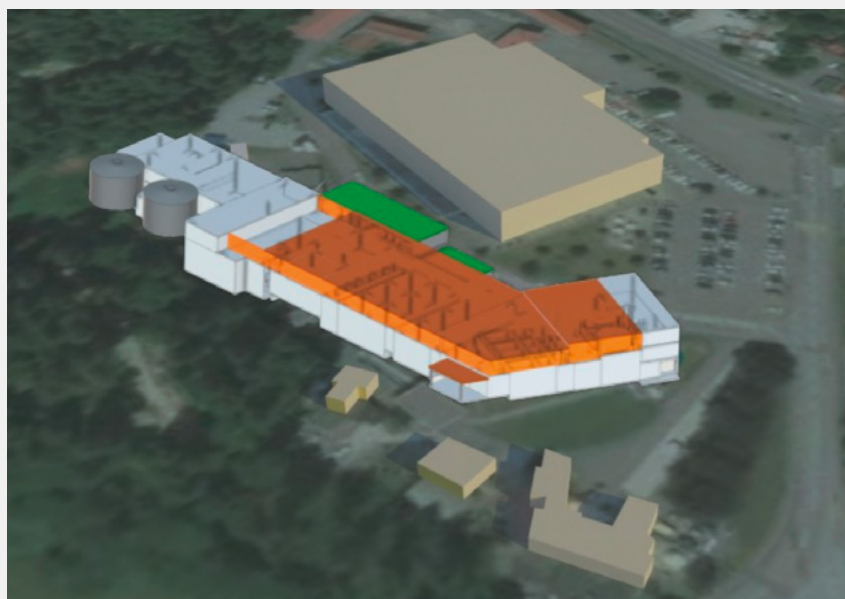
Fig. 1 Vue schématique provisoire de la future station d'épuration de la ville du Locle. De gauche à droite: le traitement des boues, le traitement de micropolluants, le traitement biologique des eaux, et les prétraitements.
